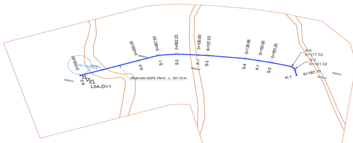
Figura 5. Pamje të planit të profilit të tubacionit 0 nga SP Përlepnica në ITU Përlepnica
